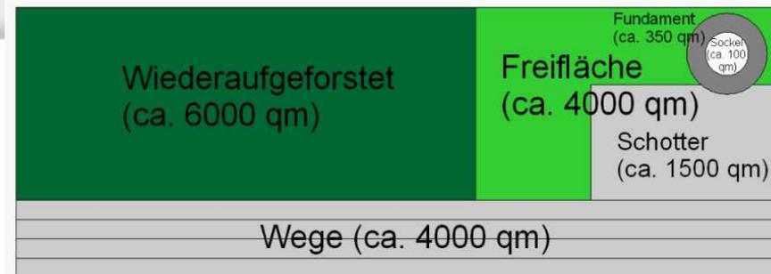
Abbildung 1: durchschnittlicher Flächenbedarf einer Windenergieanlage
